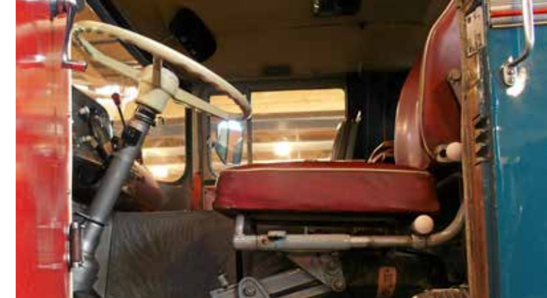
Blick in die „Holländerkabine“. Der hoch liegende Motortunnel lässt auf die Bauart des Normallenkens schliessen.
