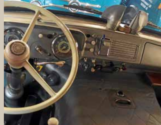
Blick in die „Holländerkabine“. Der hoch liegende Motortunnel lässt auf die Bauart des Normallenkens schliessen.
