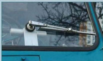
Typisches Detail: In der Schweiz wurden die Scheibenwischer mit Druckluft betätigt.
